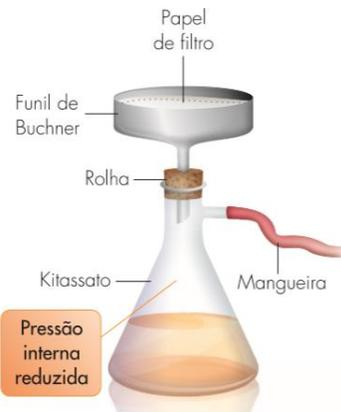
Esquema de uma filtração a vácuo
